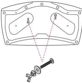
2 Schrauben zur Befestigung des Standfußes,
