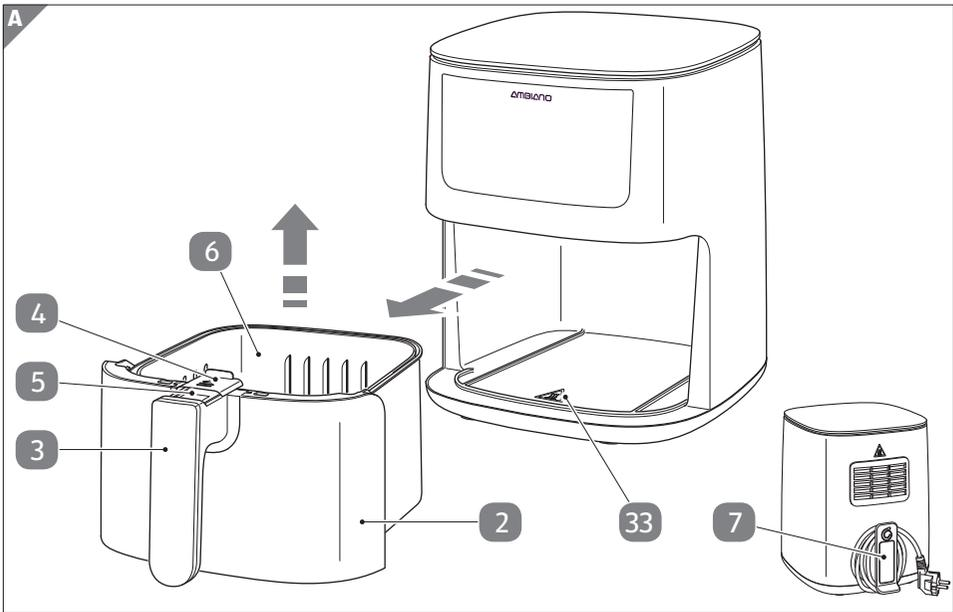
**i** Ziehen Sie den Einschub **2** am Garkorbgriff **3** aus dem Gerät, siehe **Abb. A**. Schieben Sie die Schutzklappe **4** nach vorne und drücken Sie die Garkorbbarrierung **5**, um den Garkorb **6** entnehmen zu können.
