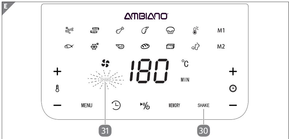
1. Berühren Sie vor oder nach dem Programmstart das Sensor-Feld **SHAKE** 30. Das Symbol **SHAKE** 31 leuchtet dauerhaft.
