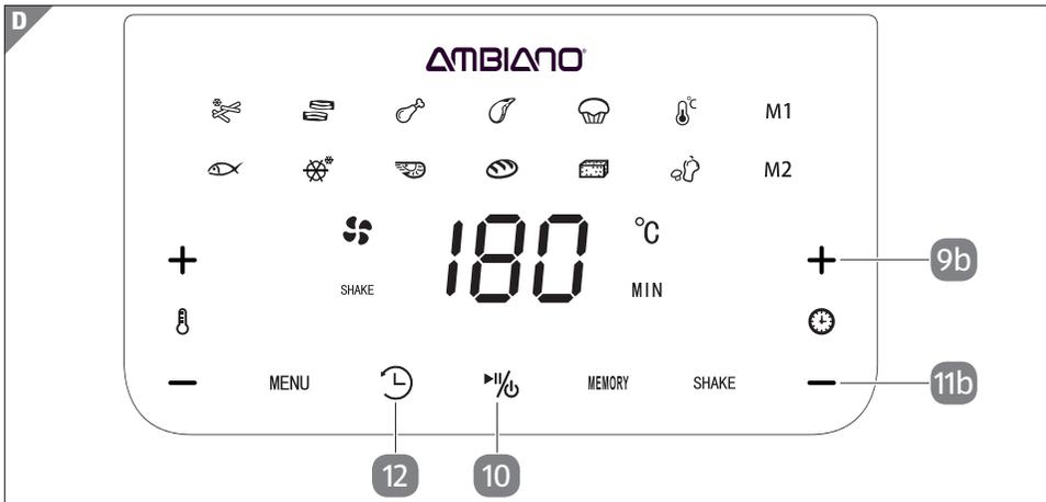
4. Berühren Sie das Sensor-Feld **10** **▶|/|**, um den Timer zu starten. Das Sensor-Feld **12** blinkt und im Display wird die verbleibende Zeit bis zum Programmstart angezeigt. Nach dem Ablauf der eingestellten Minuten startet der Garvorgang.
