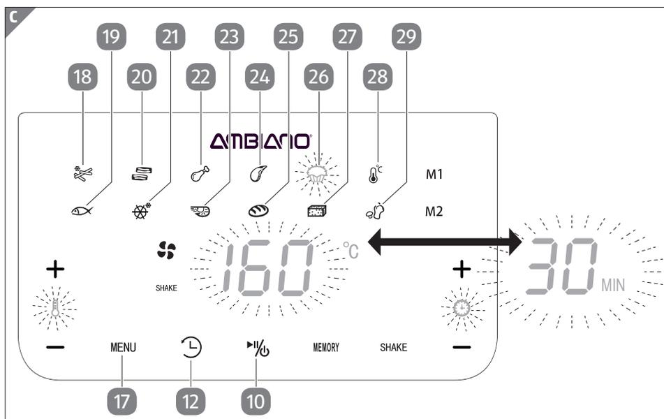
**i** Es wird abwechselnd zunächst blinkend die Temperatur des Programms und anschließend die Zeit angezeigt. Die Garzeit und/oder die Temperatur können jederzeit nach Bedarf wie unter **Manuelle Vorwahl der Garzeit und der Temperatur** beschrieben vor, sowie während des Betriebes geändert werden.
